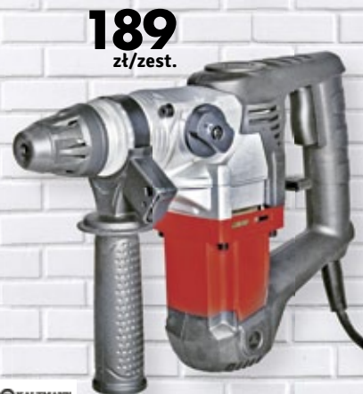
MŁOTOWIERTARKA 900 W siła uderu 4 J; obroty 880 min -1 ; maks. śr. wiercenia: w stali 13 mm, w betonie 26 mm, w drewnie 40 mm w zestawie 3 wiertła
