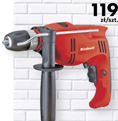
WIERTARKA UDAROWA 710 W liczba obrotów 0-2700/min, liczba uderzeń 43200 min -1 , średnica wiercenia w: betonie 13 mm, stali 10 mm, drewnie 25 mm, zakres uchwytu wiertarskiego 13 mm, bezstopniowa regulacja prędkości obrotowej
